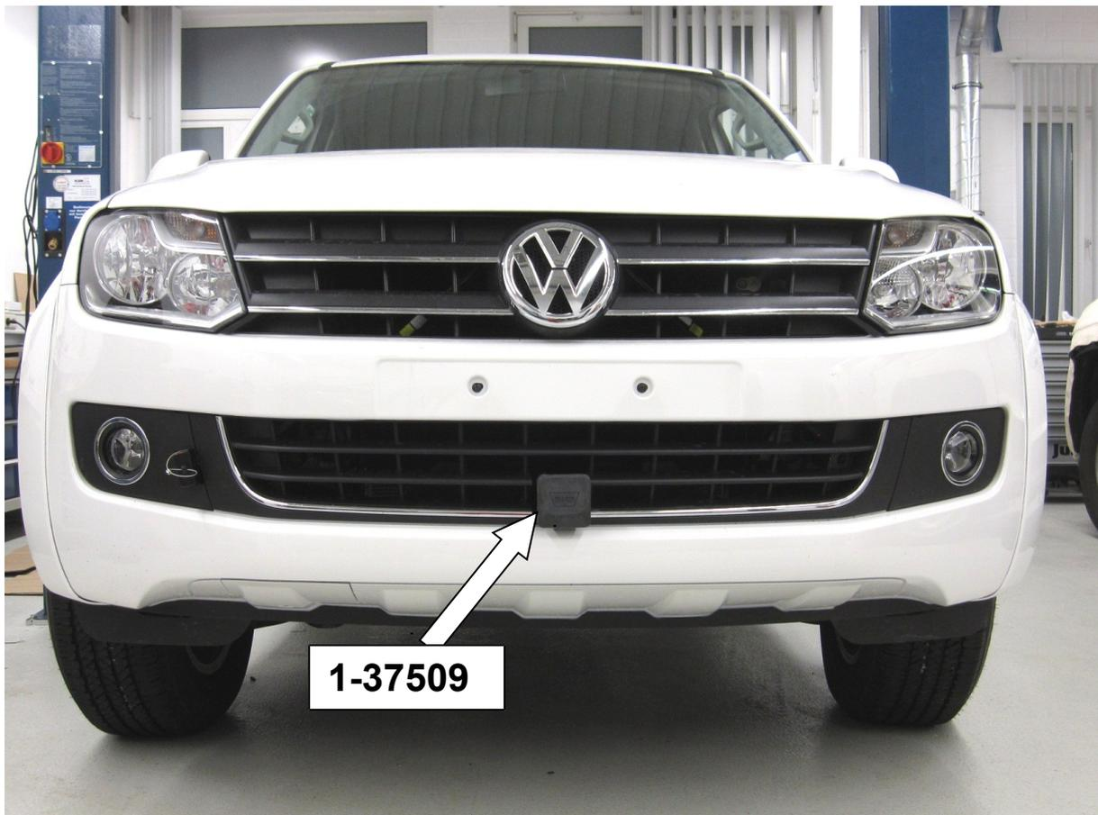
**Hier sehen sie die fertig montierte Frontaufnahme.
