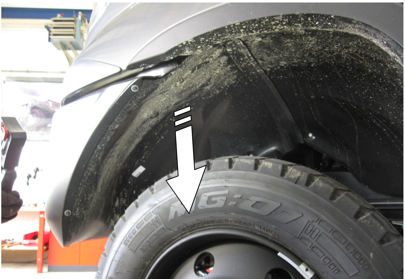
2 Vorderen Radeinbau ausbauen / Remove front mudgarde! Das Gleiche an der rechten Seite! / The same at the right side!
