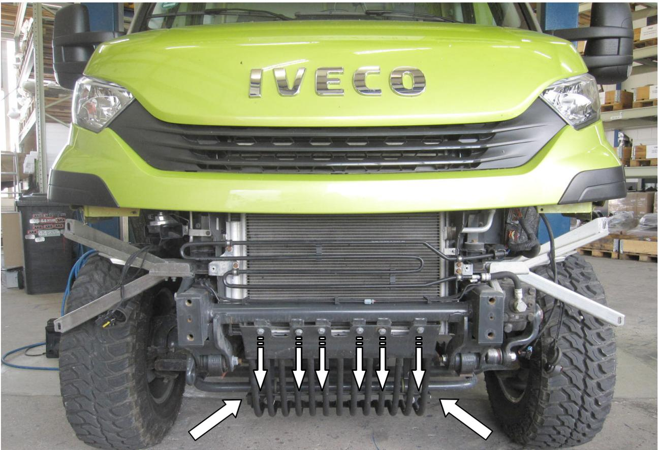
**7** **Obere Schrauben entfernen, untere Schrauben nur lösen!**
