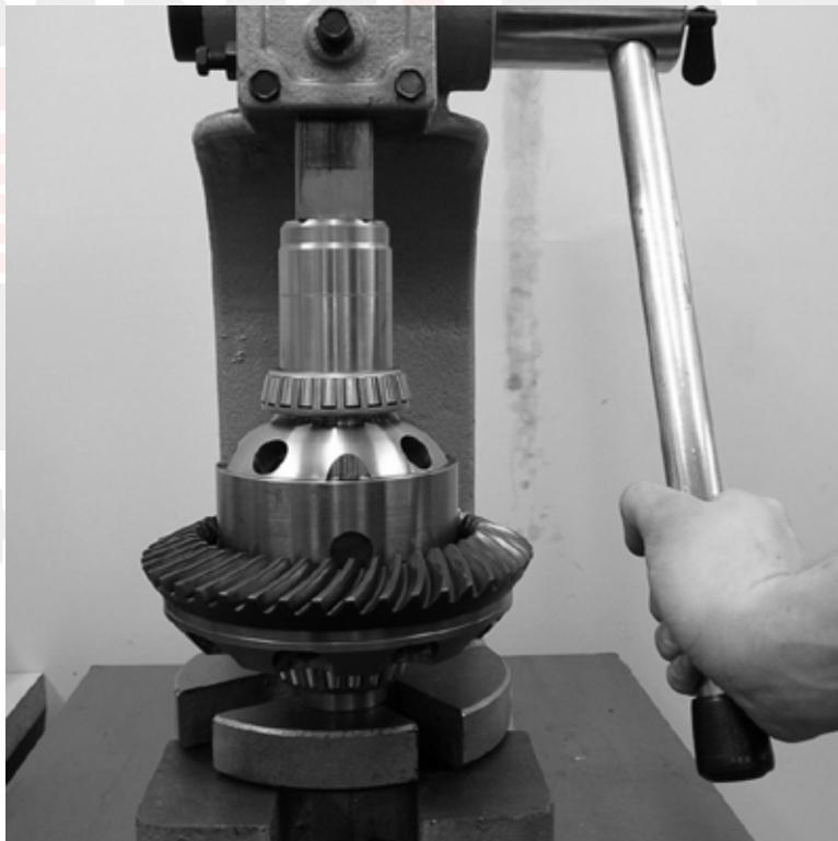
**ANMERKUNG:** Setzen Sie keine Distanzscheiben zwischen dem Walzenlager auf der Seite des Dichtringgehäuses und dessen Lagersitz ein.
