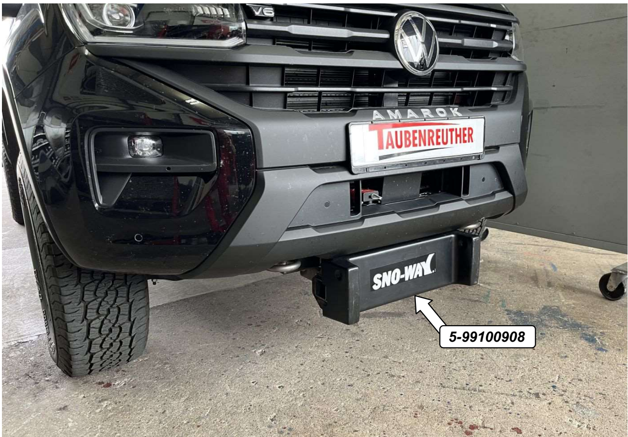
13 Bei Fahrten ohne Schneeflug muss die Aufnahme "E" mit der Kunststoffabdeckung Best.Nr.: 5-99100908 abgedeckt werden.
