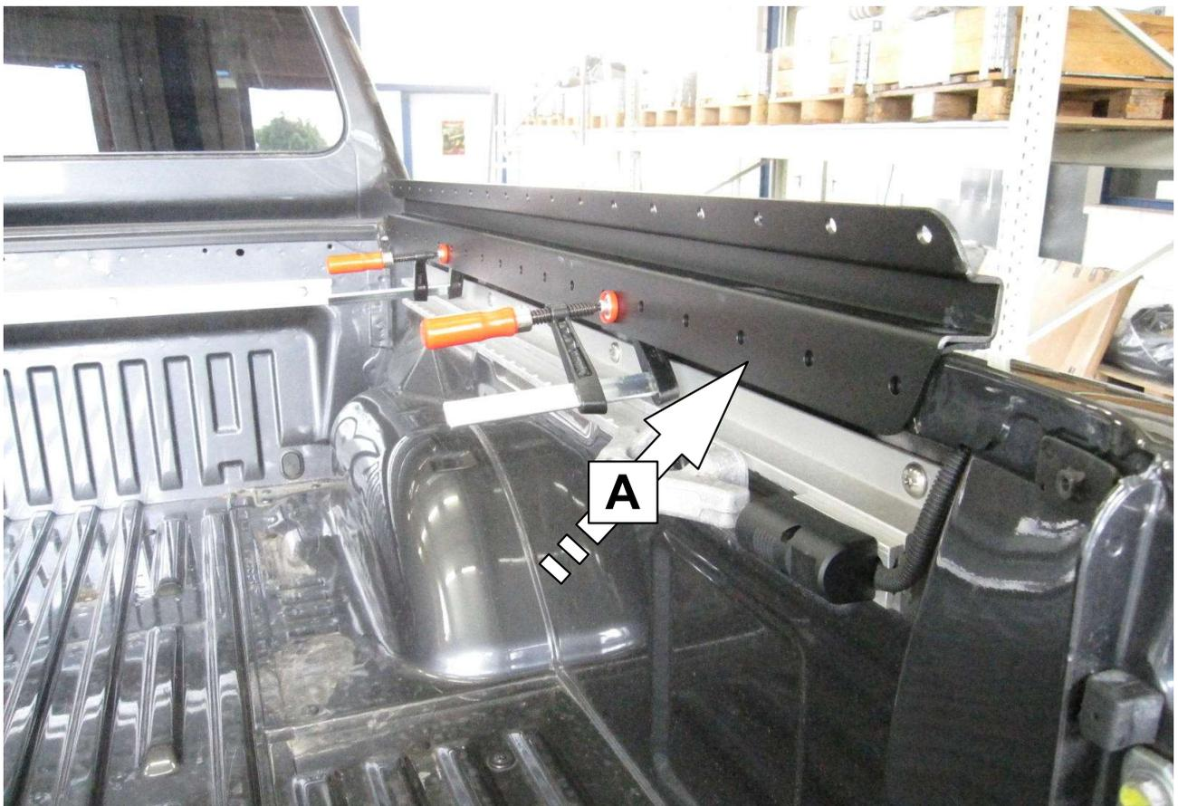
**2** **Trägerschiene aufsetzen, ausrichten und fixieren!**
