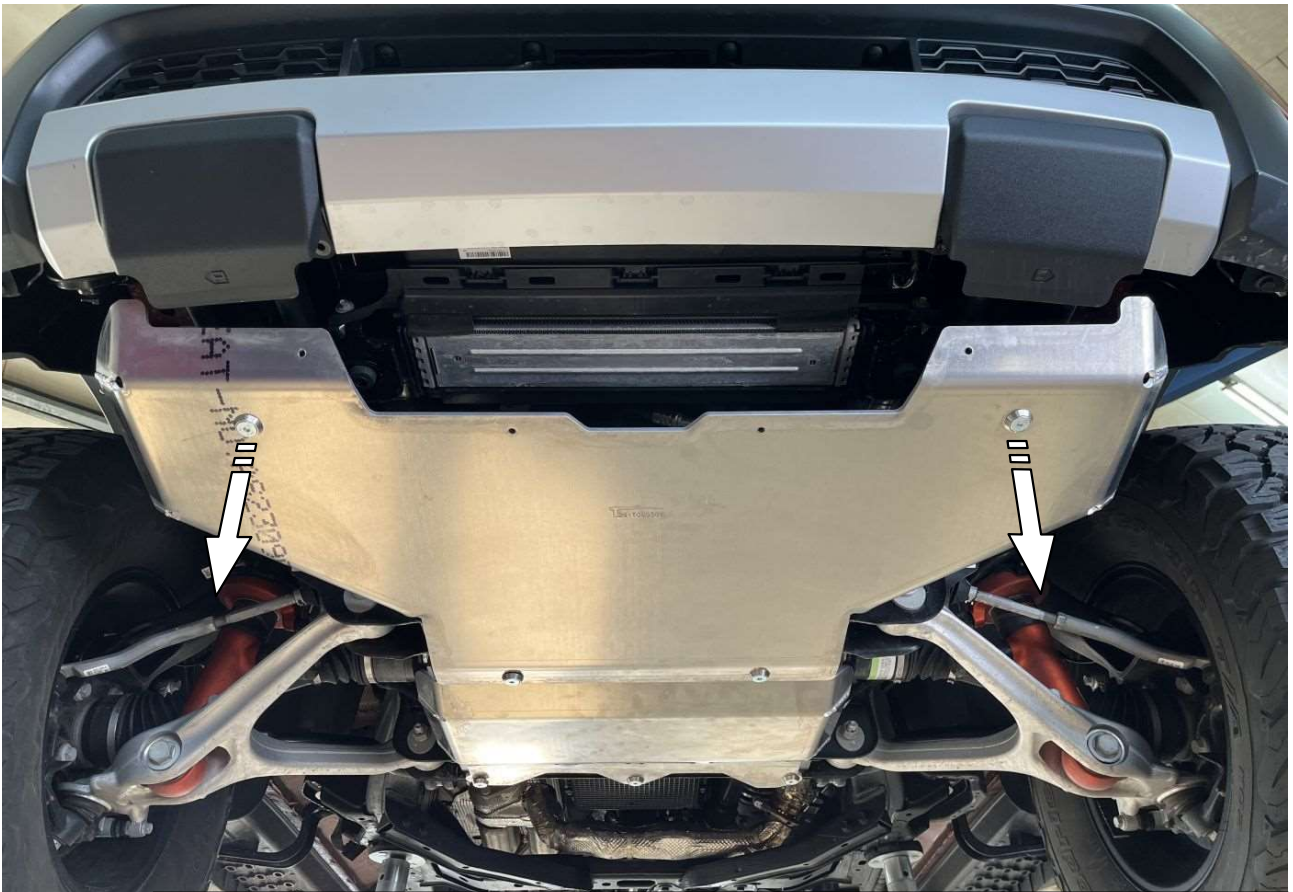
9 Für die Abdeckung „E“ vordere Schrauben entfernen! Remove the front screws for the cover „E“!
