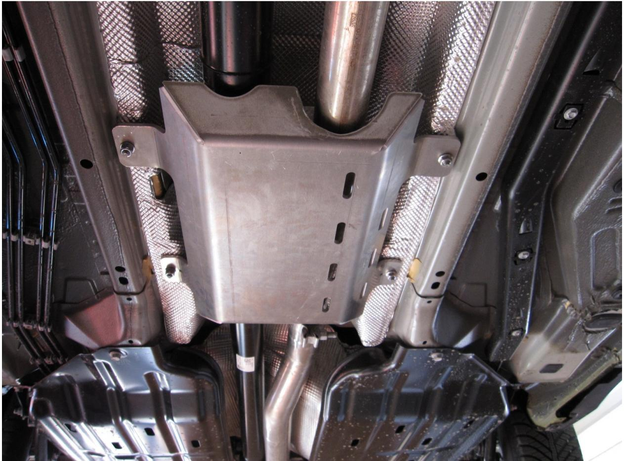
**Hier sehen sie den fertig montierten Unterfahrschutz.
