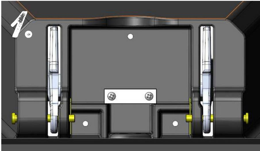
**SCHRITT 1:** BEFESTIGEN SIE DIE SCHLOSSSTÜTZE MIT DEN MITGELIEFERTEN SCHRAUBEN AN DER SCHUBLADE. RICHTEN SIE DIE STÜTZE WIE GEZEIGT AN DEN WÄNDEN DES SCHLOSSHOHLRAUMS AUS. SCHRAUBEN NICHT ZU FEST ANZIEHEN!
